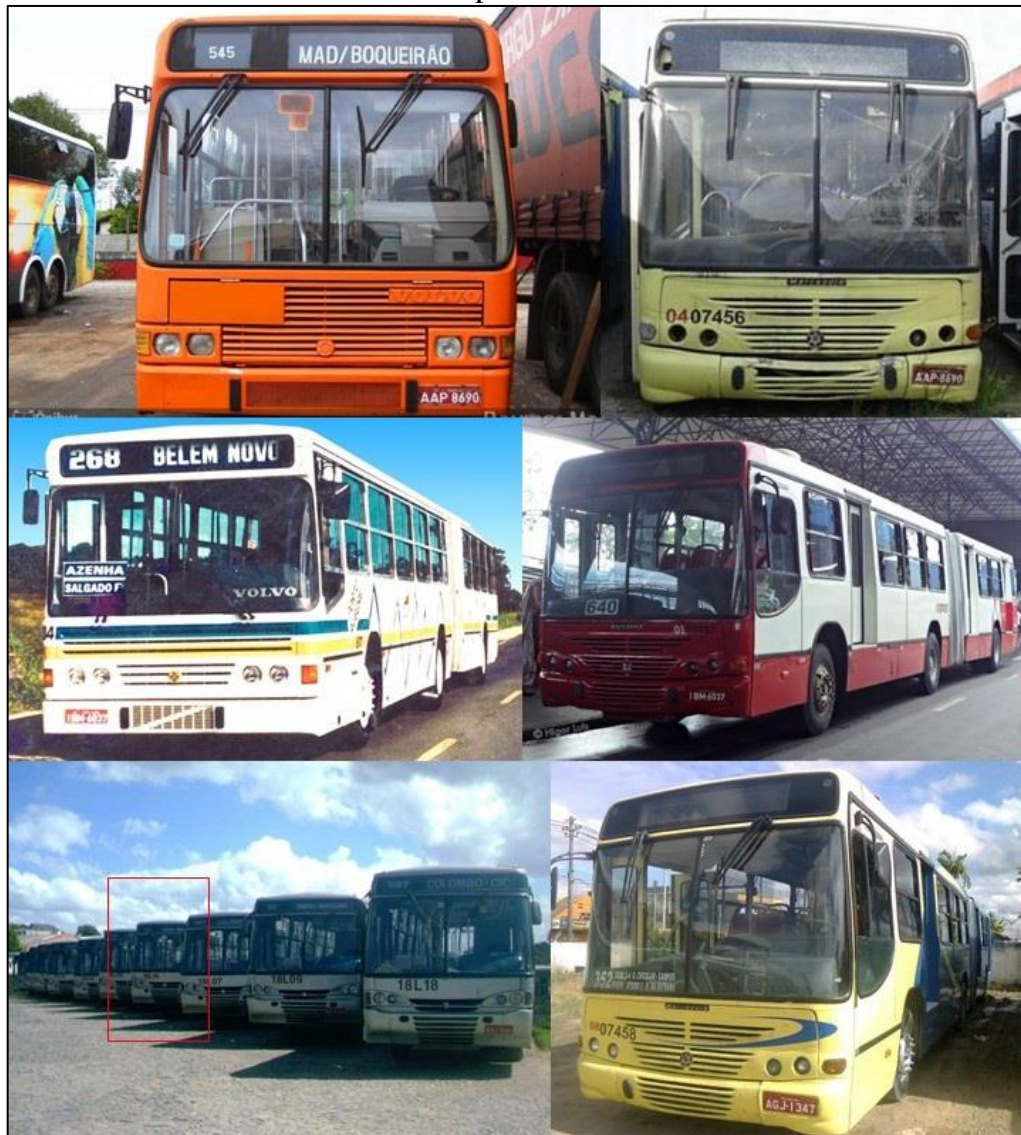
Figura 5 - Veículos reencarroçados com data de fabricação de 2007 e 2008. Na esquerda estão os veículos com a primeira carroceria e na direita os veículos reencarroçados operando no transporte coletivo.
