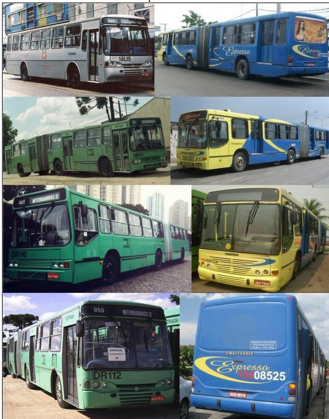
Figura 6 - Veículos reencarroçados com data de fabricação de 2007 e 2008. À esquerda estão os veículos com a primeira carroceria e à direita os veículos reencarroçados operando no transporte coletivo.
