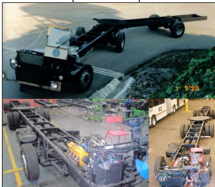
Figura 2 - Chassis de ônibus convencionais transformados em chassis articulados pela empresa Tutto Transporti.
