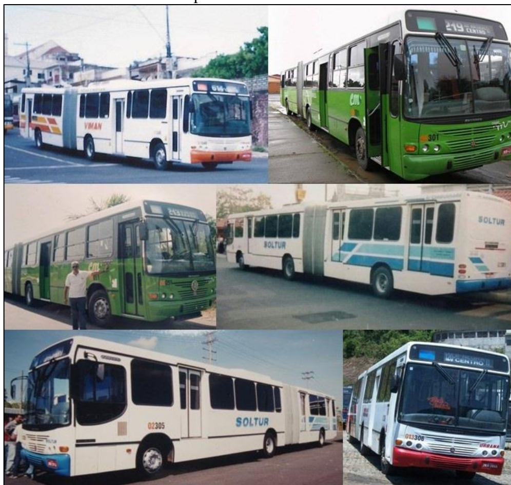
Figura 3 - Ônibus articulados produzidos a partir de chassi convencionais que operaram no sistema de transporte coletivo da cidade de Manaus.
