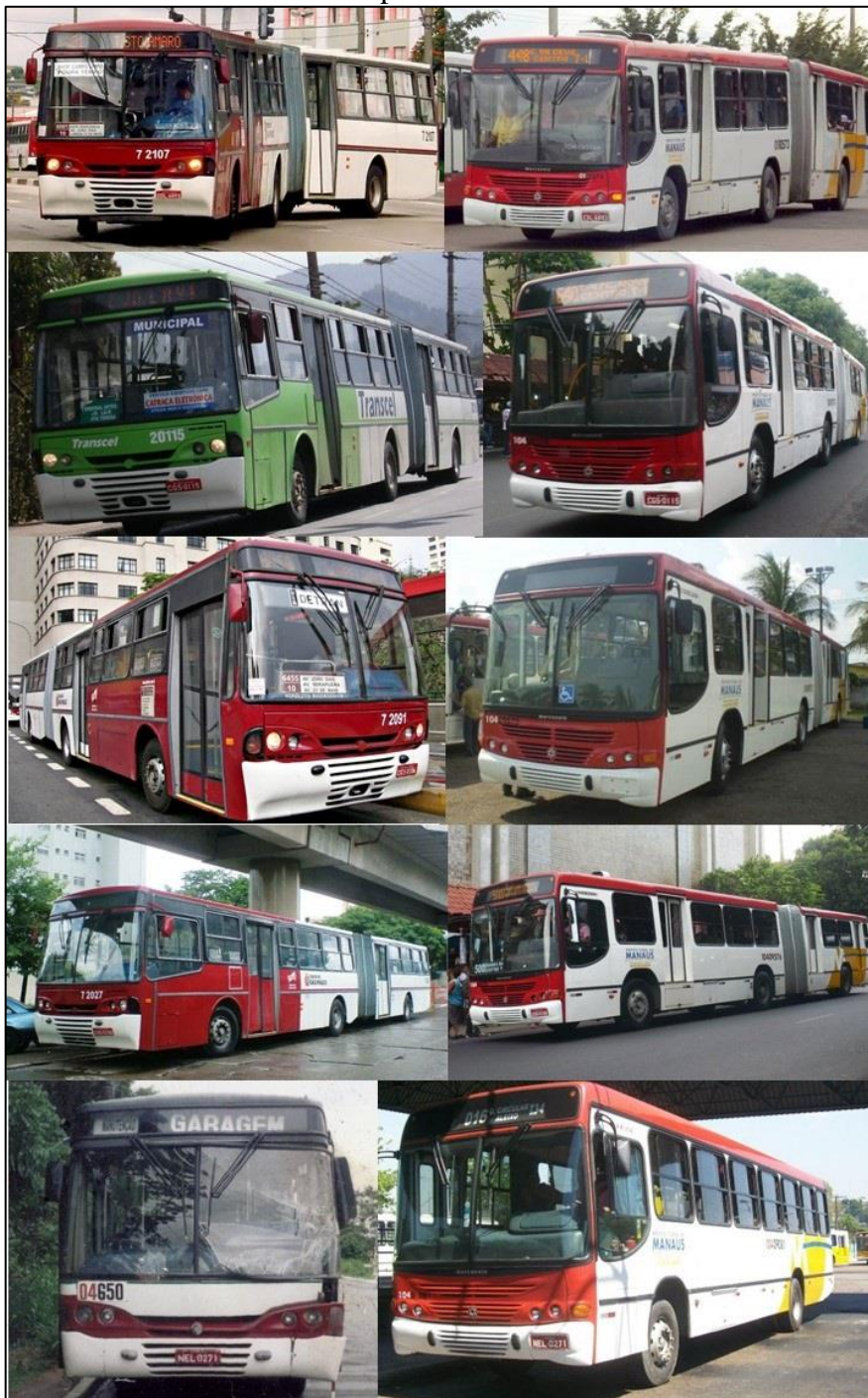
Figura 7 - Veículos reencarroçados com data de fabricação de 2009. À esquerda estão os veículos com a primeira carroceria e à direita os veículos reencarroçados operando no transporte coletivo.
