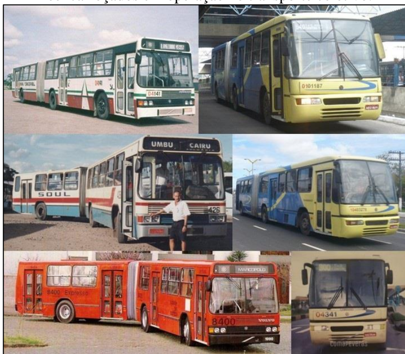
Figura 1 - Ônibus articulados reencarroçados que operaram no transporte coletivo de Manaus. À esquerda, os veículos com a primeira carroceria e, à direita, os veículos reencarroçados em operação no transporte coletivo.
