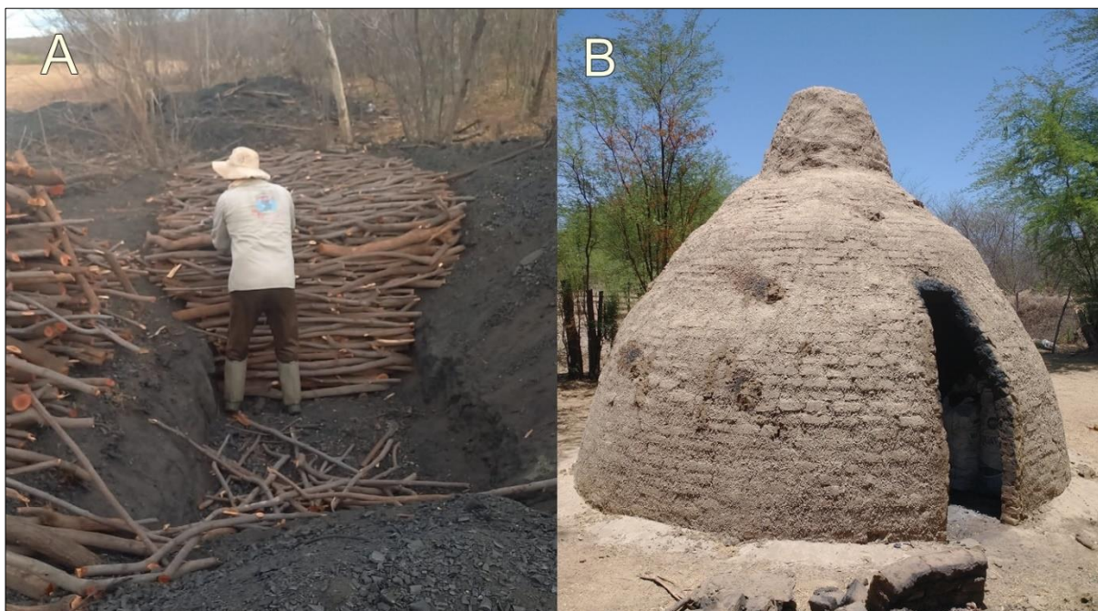
Figura 5: Carvoeiras de chão (A) e forno (B) em Várzea/PB
